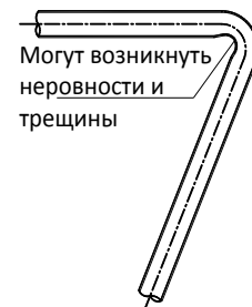
Рисунок 3-5.3: Угол изгиба превышает 90°
